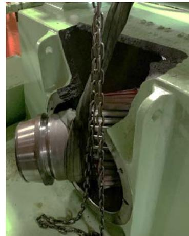
So konnte innerhalb einer Woche die Inspektion des Getriebes vor Ort durchgeführt und der Schaden aufgenommen werden. Der Ersatz des Gehäuses war genauso notwendig wie die Neufertigung einiger Getriebeteile, sodass am Ende fast ein komplett neues Getriebe gebaut werden musste. Wie meistens bei einem Serviceeinsatz war der Zeitplan eng, denn unser Ziel ist es die Ausfallzeit eines Schiffes so gering wie möglich zu halten.
