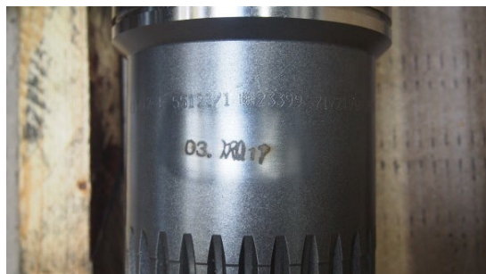
Bild 13 Ritzelwellen: hinter dem Auslauf der Mitnehmersverzahnung
