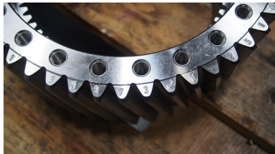
Bild 11 Kupplungsgehäuse: auf Stirnfläche, ggf. auf den Stirnflächen der Zähne
