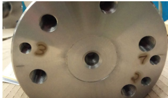
Bild 9 Abtriebswelle: Kennzeichnung mit Ätz-Stift bei drei Bohrungen
