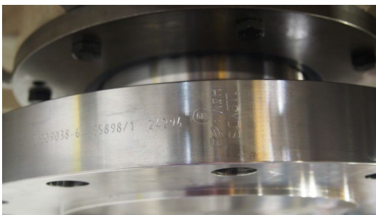
Bild 6 Flansche, Abtriebswellen, Zwischenwellen mit Flansch: am äußeren Flanschdurchmesser
