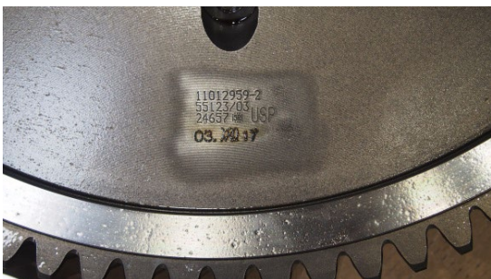
Bild 12 Zahnrad, Ritzel: am Radkörper
