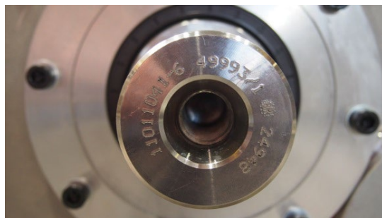
Bild 7 Antriebswellen, Abtriebswellen ohne Flansch: auf außen liegender Stirnfläche Zwischenwellen ohne Flansch: auf Stirnfläche
